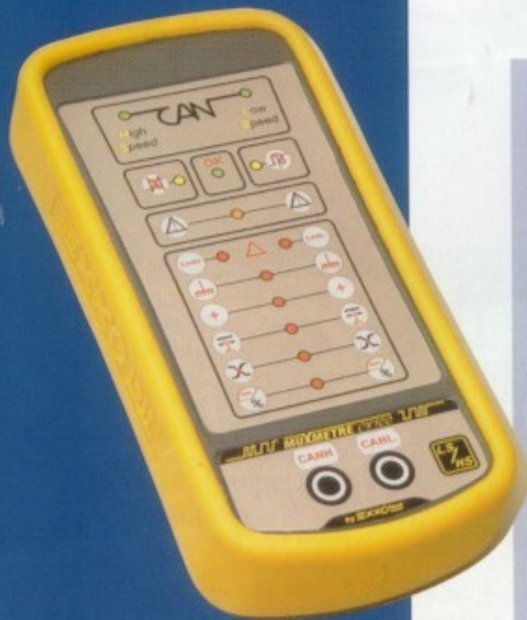
Le muxmètre permet le contrôle rapide des circuits multiplexés.
